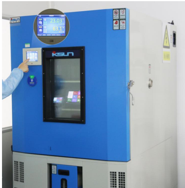
图 5-3 高低温老化测试图
